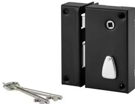
Coffre et gâche acier cambré époxy noir granitépêne et demi-tour acier en saillie de 5 mm canon alliage longueur 45 mm entrée de clé acier sur coffremécanisme à 6 gorges, 2 tours livrée avec 2 clés nickelées (20 variures) garantie 10 ans.
