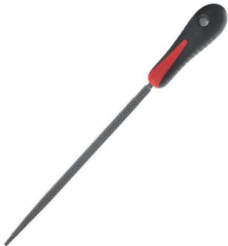
Aacier moins chargé en carbone (0,45 %) pour un travail efficace sur les matériaux tendres dureté de 53 HRCmanche bi-matière : polypropylène (résistance et relief permettant de travailler avec précision) et élastomère (souple et confortable - limite la transpiration et l'échauffement de la main).
