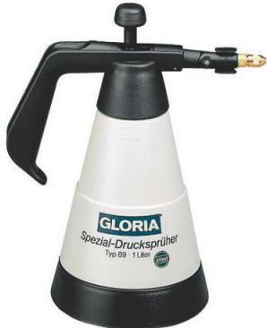
Pour l'application de liquides chimiques et à base d'huile, ainsi que pour l'entretien des machines et véhicules. Réervoir en plastique robuste, joints en FKM résistants aux huiles et solvants. Buse en laiton réglable avec tête orientable. Pompe de précision en plastique. Anneau de base pour une stabilité accrue. Soupape de sécurité intégrée. Capacité de remplissage 1 L. Capacité totale 1,45 L. Pression de service maximale 3 bar.
