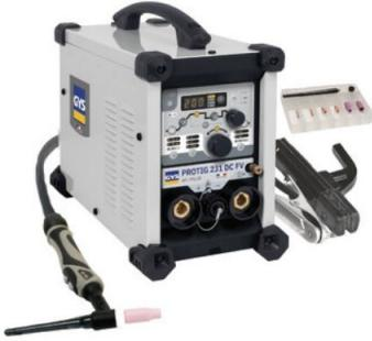
Générateur de soudage TIG en courant continu pulsé, très compact et portatif technologie PFC permettant de fonctionner de 85 V à 265 V et d'obtenir un arc électrique très stable même sur des rallonges de chantier de 100 m
