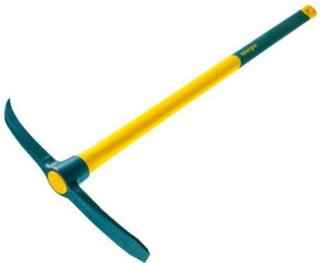
Pour manipuler les plaques d'égouts: dégager l'enrobé des bords de la plaque, soulever et faire glisser la plaque-Outil forgé et trempémanche Novagrip de 90 cm en fibre de verreun côté bec pour soulever et faire glisser la plaque , un côté panne pour dégager l'enrobé des bords de la plaquepoignée élastomère anti-glissement et anti-vibrationdiamètre douille : 48 mm.{-0-0}
