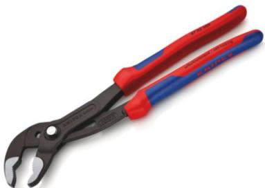
Réglage précis pour un ajustage parfait à différentes tailles de pièces et poignées ergonomiques autobloquante sur tubes et écrous intérieur des mâchoires à dents spécialement trempées, dureté d'env. 61 HRC charnière entrepassée : grande stabilité grâce au double guidage en cliquetage sur de l'axe d'articulation : pas de déréglage accidentel ergot de protection évitant les pincements acier électrique au chrome-vanadium, forgé, trempé à l'huile en plusieurs phases poignées gainage bi-matière.
