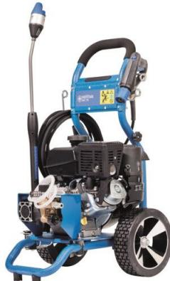
Châssis compact en acier laqué type "diable" avec roues increvables
