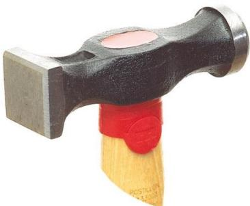
1 tête ronde quadrillée1 tête carrée pièce fine (existe en 40/35 sur demande)tête en acier à forte teneur en carbone C45Etête forgée, avec traitement thermique par induction des surfaces travaillantes (54 HRC)parties travaillantes et joues finement poliespeinture poudre époxydique par procédé électrostatique, suivi d'une cuisson au fouremmanchement réalisé par une machine hydraulique.
