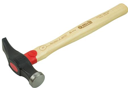
Tête rondeutilisé au départ par les chaudronniers, pour donner une forme aux tôles tête en acier à forte teneur en carbone C45E. Tête forgée, avec traitement thermique par induction des surfaces travaillantes (54 HRC) parties travaillantes poliespeinture poudre époxydique par procédé électrostatique, suivi d'une cuisson au four.manche Hickory : bois dur de densité élevée, adapté aux usages intensifs ou fréquents.
