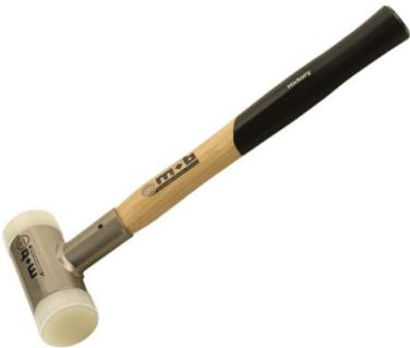
Embouts interchangeables matière : TPU : polyuréthane thermoplastique dureté 80D Shoretête en acier à forte teneur en Carbone C45, remplie de billes d'acier pour un effet sans recul section ronde manche en bois dur Hickory.
