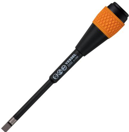
Lame renforcée avec traitement CR-V anti-corrosionlame fine ( $\varnothing$  6 mm vs  $\varnothing$  8 mm pour un tournevis standard) empêchant l'endommagement du bornierrevêtement de la lame contre les accidents de court-circuitaimant intégré dans la lame permettant de maintenir fermement les vis en place.
