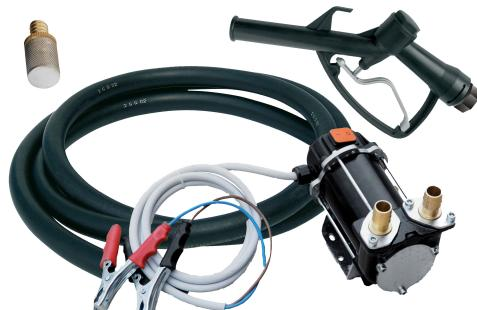
Pour gazole et fuel cycle de travail : 30 min raccordement 3/4" composé de : 1 pompe à palette auto-amorçante 12 V/150 W - débit 50 L/min - munie d'un système BYPASS, d'un interrupteur de mise en service et d'une protection par fusible 1 flexible de 4 m, Ø : 20 mm 1 crépine d'aspiration 1 pistoletplastique 1 câble d'alimentation de 2 m avec pinces.
