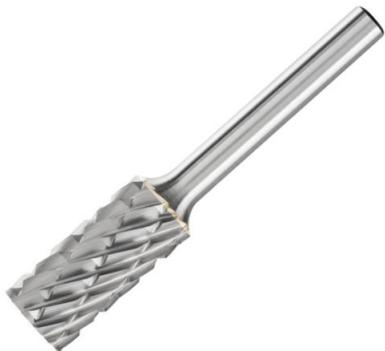
Applications : métal non ferreux, bronze, cuivre, laiton, zinc, plastiques pour fraisage, égalisation, ébavurage, usinage des surfaces et des cordons de soudure
