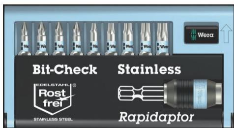
Coffret de 10 pièces comprenant 1 porte-embouts Rapidaptor inox à changement rapide et 9 embouts inox. utilisation préconisée avec des vis inox composition : - 1 porte embout 3888/4/1 K 1/4 50mm - 1 embout 3851/1 TS PH : PH 2 x 25mm -3 embouts 3855/1 TS PZ : 1 PZ1 x 25mm - 2 PZ2 x 25mm - 5 embouts 3867/1 TS TORX® : TX10 - TX15 - TX20 - TX25 - TX30 x 25 mm particulièrement préconisé pour la pose de vis terrasse et la pose d'éléments décoratifs.
