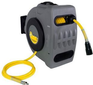
Carter ABS livré avec flexible de raccordement 1 m et support orientable et amovible, système automatique de guidage flexible. Matériau du tuyau : pvc Ø de tuyau intérieur / extérieur (mm) : 10x16 Longueur de tuyau (m) : 20 Dimensions (mm) : 450x410 Poids (kg) : 9.8 Entrée : 3/8" Gaz (M) Pression (bar) : 12
