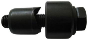
Emporte-pièces à tôles en acier carbone brunis permet de découper des trous sans bavure et non déformés dans des matériaux tels que l'aluminium, tube isolant, laiton et aciers doux jusqu'à 2 mm d'épaisseur prévoir le perçage d'un pré-trou d'un diamètre légèrement supérieur à celui de la vis de l'emporte-pièces.
