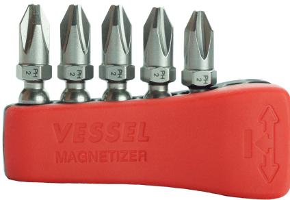
Embout à chocs Impact Ball haute durabilité (30x plus résistant) fabriqué en alliage VoHA VESSEL haute durabilité 62HRC conception avec double zone de torsion et bille d'absorption des chocs assurant plus de longévité de l'embout et moins de destruction de la vis idéal pour les visseuses à chocs et à puissante motorisation fourni en étui magnétiseur en plastique avec inserts de rangement des embouts permettant de magnétiser et démagnétiser l'embout souhaité étui magnétiseur de 5 embouts 30 mm.
