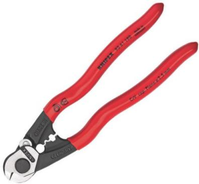
Forte démultiplication poignées gainées en plastique convient aux câbles métalliques, aciers ronds avec 2 profils de sertissage pour embouts sur gaine de câble Bowden et embouts pour câble de traction dureté des tranchants env. 64 HRC.
