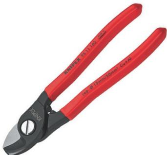
Pour couper les câbles en cuivre et en aluminium, unifilaires et multifilaires. Ne convient ni à la coupe du fil d'acier ni à des conducteurs en cuivre étirés à froid, rachants trempés, meulés avec précision. Coupe nette du câble et sans écrasement. Coupe facile avec prise d'une seule main. Poignée de protection évitant les pincements. Harnière vissée réglable, sécurité automatique. Cier à outils de qualité spéciale, forgé, trempé à l'huile, version brune, poignées gainées en plastique.
