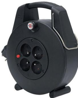
Bouton tournant avec logostar pour un enroulement facile du câble poignée ergonomique avec un crochet métallique escamotable permettant d'accrocher l'appareil aisément puissance maxi sous 230V : 2300W avec disjoncteur thermique.
