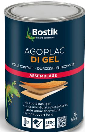
Colle pour le placage de stratifiés décoratifs sur supports rigides convient également pour le collage de liège, caoutchouc, cuir, polyester ou métaux prise initiale puissante haute tenue thermique (durcisseur incorporé) température mini d'utilisation : + 15° C temps de séchage : 15 à 20 minutes temps d'ouverture maximum : 60 à 90 minutes sans toluène et sans cyclohexane.
