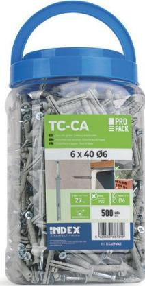
Pré-perçage avec vis à tête fraisée PZ peut être utilisée dans les matériaux creux et pleins s'installe facilement avec un coup de marteau grâce à son filetage et à sa pointe de type harpon doté d'une colerette fraisée qui lui permet d'affleurer le matériau de base le bouchon est en nylon et la vis en acier zingué.
