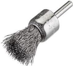
Brosse pinceau recommandée pour les endroits difficiles d'accès et les zones internes. Pour cardage, ébavurage, enlèvement de laque et de scories, détartrage, dépolissage, nettoyage. Particulièrement adaptée pour l'élimination de bavures, scories, calamines, peinture, rouille, revêtements, caoutchouc, résidants incandescents et autres souillures dans des endroits difficilement accessibles.
