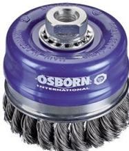
Brosse coupe à haute performance pour la finition de surface. La bague amovible évite l'écartement du garnissage. Il est possible d'enlever la bague une fois les fils usés, afin d'augmenter la durée de vie de la brosse. Pour l'enlèvement de scories, de rouille, l'ébavurage et le nettoyage.
