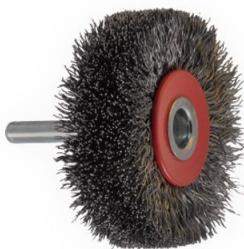
Brosse avec une densité de garnissage moyenne pour des applications légères et moyennes à haute vitesse. Vitesse de travail recommandée : environ 50% du tr/min max. Pour les travaux de nettoyage non destructifs et légers, l'ébavurage et le traitement des alésages.
